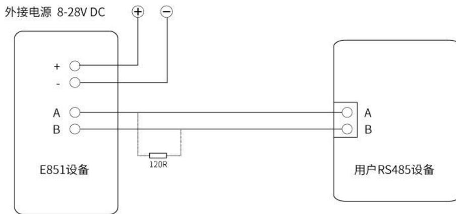
注：485 总线高频信号传输时，信号波长相对传输线较短，信号在传输线终端会形成反射波，干扰原信号，所以需要在传输线末端加终端电阻，使信号到达传输线末端后不反射。终端电阻应该与通讯电缆的阻抗相同，典型值为 120 欧姆。其作用是匹配总线阻抗，提高数据通信的抗干扰性及可靠行。
