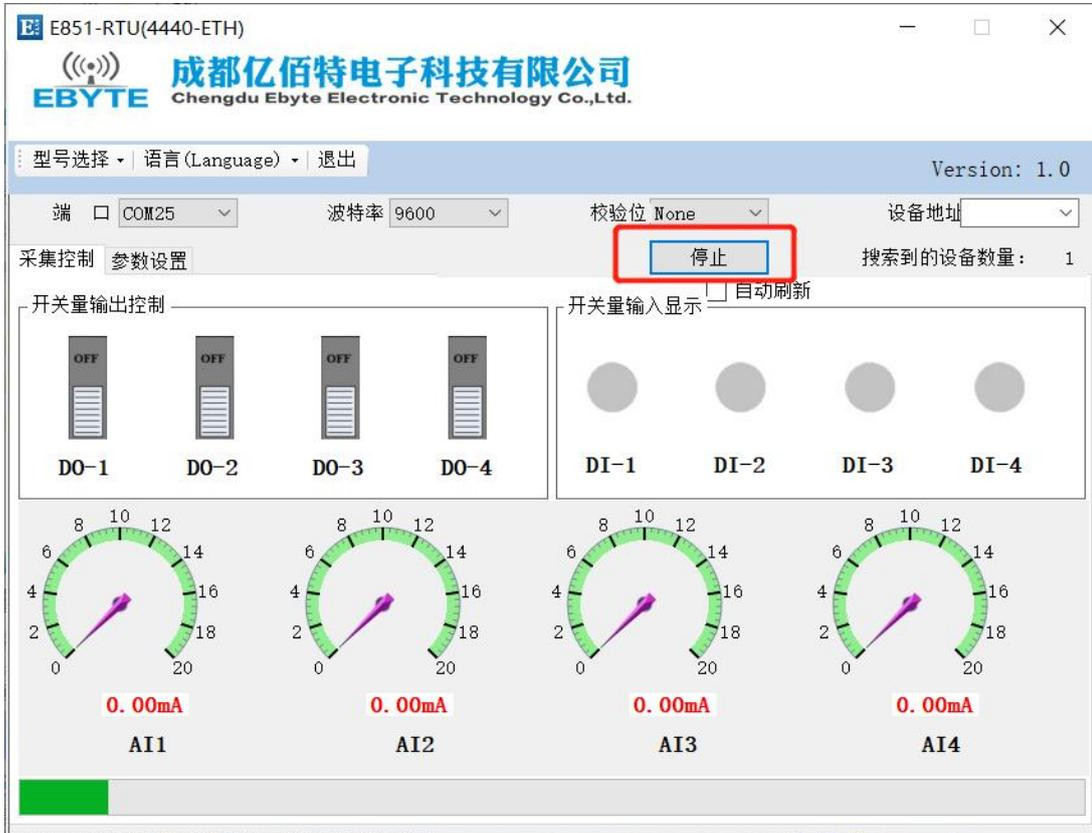
这时，可看到当前设备的设备地址，对“自动刷新”√处理，可进行开关量输出控制、开关量输入读取、差分模拟量输入读取。
